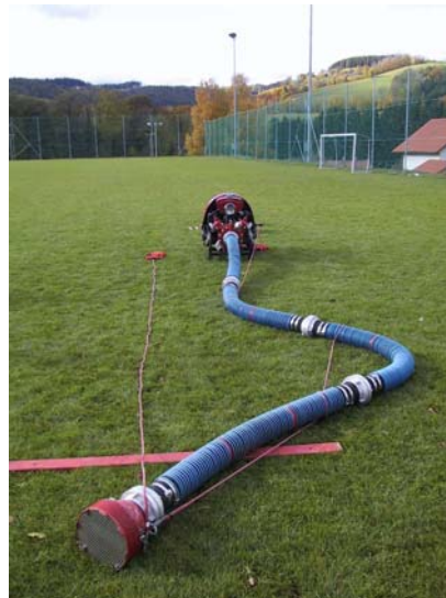
Bild 11 Richtig ausgelegte Saugschlauchleitung
